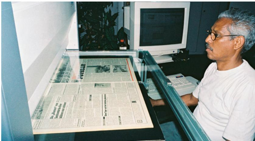
In wenigen Sekunden fährt der großformatige Scanner über die Doppelseite. Entscheidend ist ein mechanischer Zusatz zu der Buchwippe, der die Zeitungssseiten völlig plan hält, ohne den Band zu beschädigen. Für höchste Scann-Genauigkeit wurde der massive Metallaufbau mikrometergenau justiert.
